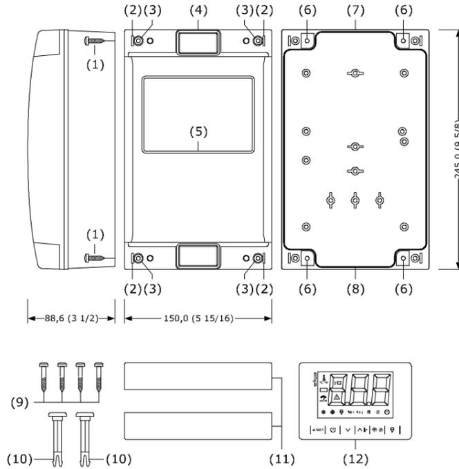
1. Fissare il guscio posteriore (7) alla parete con 4 viti (1) utilizzando gli appositi fori (6).
