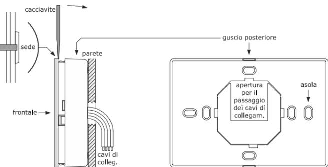
**1.2 Modelli per installazione a parete con alloggiamento posteriore per scatola da incasso**
