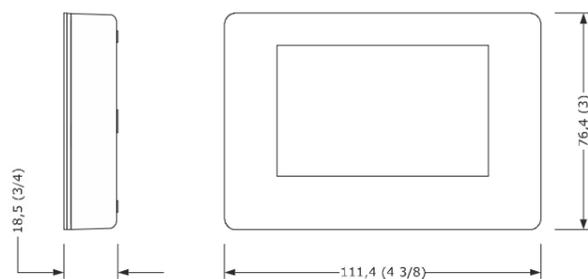
Installazione a parete (con tasselli e viti di fissaggio) o nelle più comuni scatola da incasso (con viti di fissaggio).
