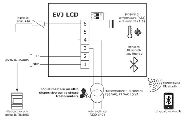
**2.1.3 Collegamento elettrico con dispositivo alimentato da un controllore (per esempio c-pro 3 OEM)**
