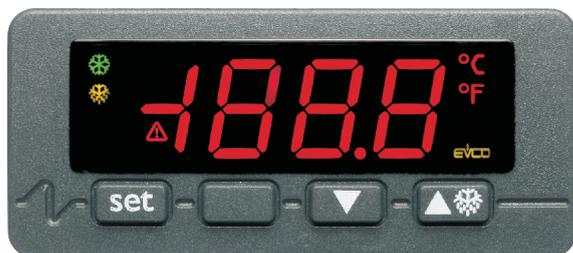
EVK441 è un controllore digitale "differenziale" a una uscita per semplici chiller; il dispositivo trova impiego in quelle applicazioni dove è richiesto che la temperatura in uscita si differenzi da quella in ingresso di un determinato valore, in un campo di lavoro compreso tra -50 °C e 150 °C.
