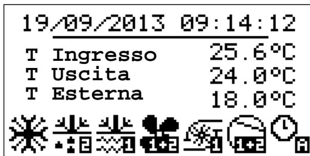
In basso alla pagina sono visualizzate delle icone per indicare alcuni stati di funzionamento del circuito.
