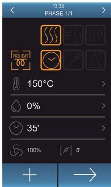
Selezione del preriscaldamento, del tipo di cottura e del metodo di controllo fase.
