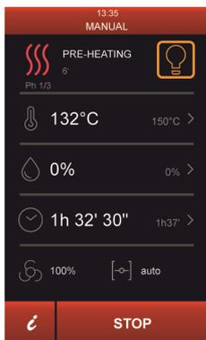
Avvio del ciclo di cottura e Preriscaldamento
