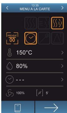
Schermata impostazione tipo di cottura/temperatura/umidità/ventilazione per tutto il ciclo. Oppure viene richiamata ricetta da ricettario
