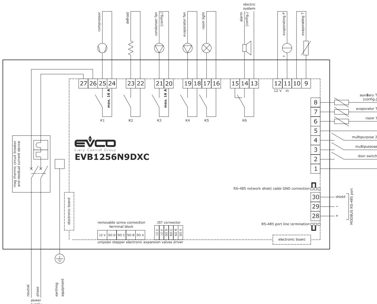
Raccordement électrique pour les modèles avec data logging pour conformité à la règle EN 12830 (pour exemple EVB1214N9XLC).
