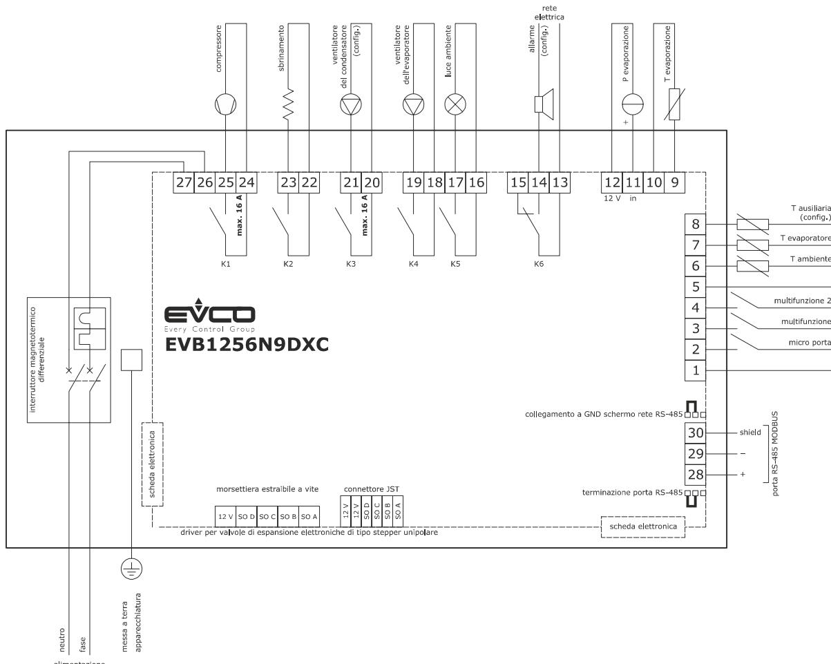
Collegamento elettrico per i modelli con data logging per conformità alla norma EN 12830 (per esempio EVB1214N9XLC).
