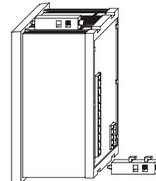
installazione con staffe a vite; per evitare di danneggiare il contenitore e le staffe a vite, modellare la coppia di serraggio.
