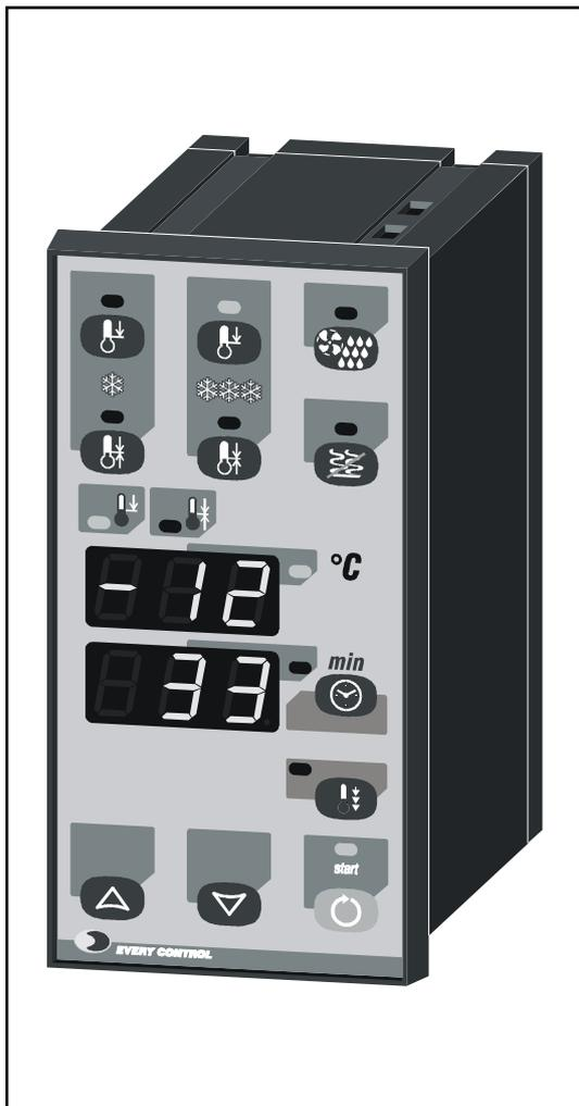
**EC 8-825** è un controllore digitale con **regolazione della temperatura di tipo ON-OFF**, studiato per la gestione di abbattitori rapidi della temperatura di derrate (a temperatura ambiente o precotte) attraverso il controllo dell'attività del compressore, dei ventilatori dell'evaporatore, degli sbrinamenti (per tempo-temperatura) ed il comando della luce della cella.
