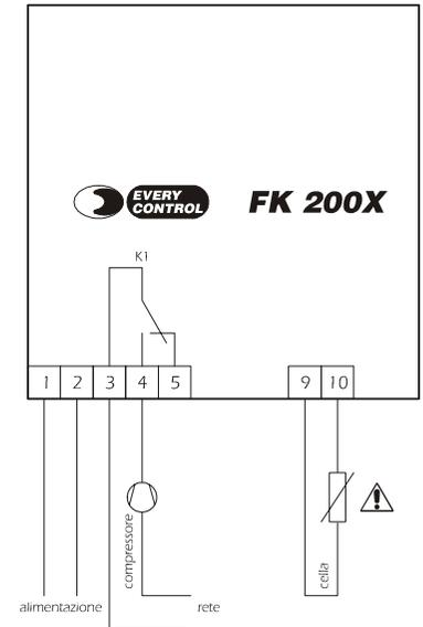
La sonda è connessa ad un terminale della tensione di rete; per evitare scosse, utilizzare sonde con doppio isolamento.
