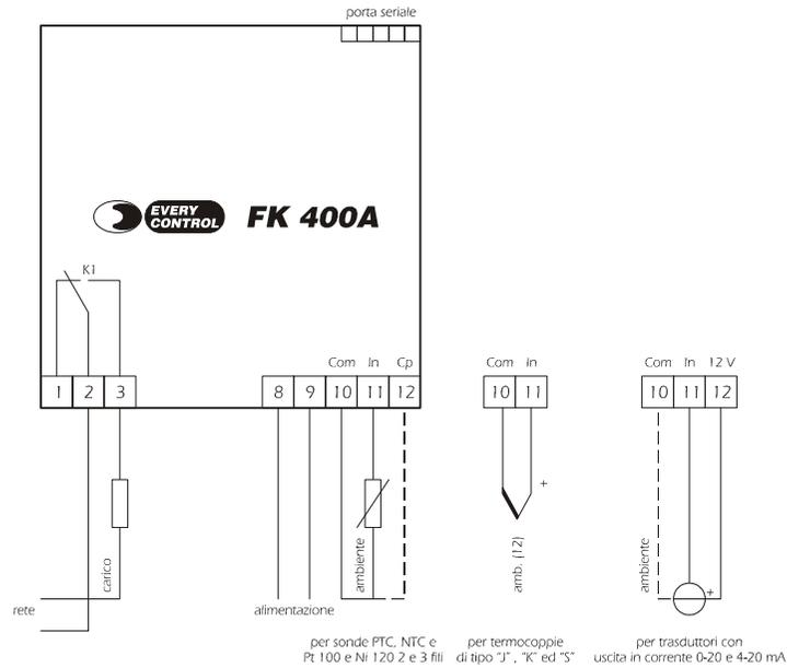
(12) dotare la sonda di una protezione in grado di isolarla contro eventuali contatti con le parti metalliche o utilizzare una sonda isolata.
