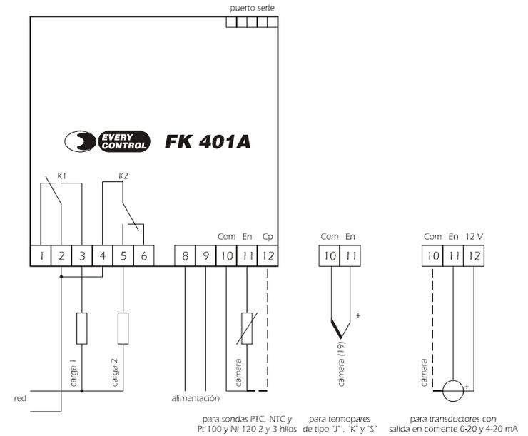
[19] dotar la sonda de una protección capaz de aislarla contra eventuales contactos con las partes metálicas o utilizar una sonda aislada.
