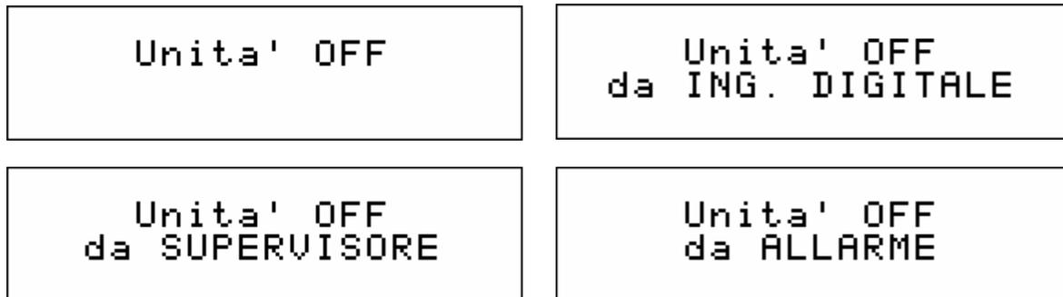
L'unità in *OFF da allarme* può essere spenta completamente mediante tasto, ingresso digitale o supervisore.
