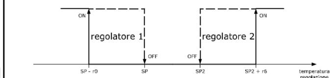
Regolazione per caldo setpoint 1 (r5 = 1) e regolazione per caldo setpoint 2 (r10 = 1).
