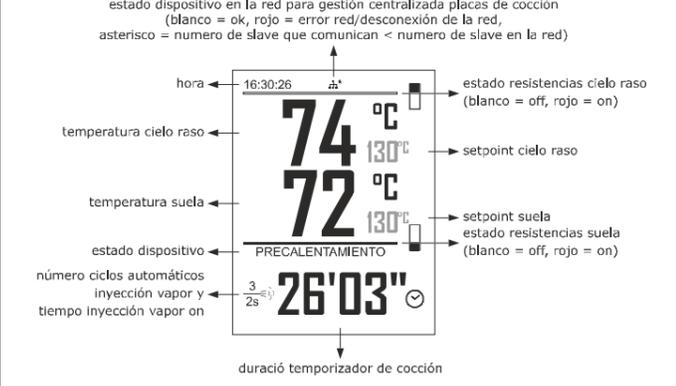
Si se han alcanzado el setpoint cielo raso y el setpoint suelo, el estado del dispositivo visualiza «LISTO», en caso contrario visualiza «PRECALENTAMIENTO».
