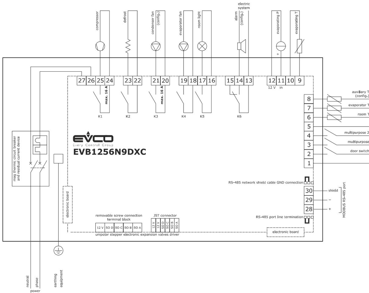
Raccordement électrique pour les modèles avec data logging pour conformité à la règle EN 12830 (pour exemple EVB1214N9XLC).
