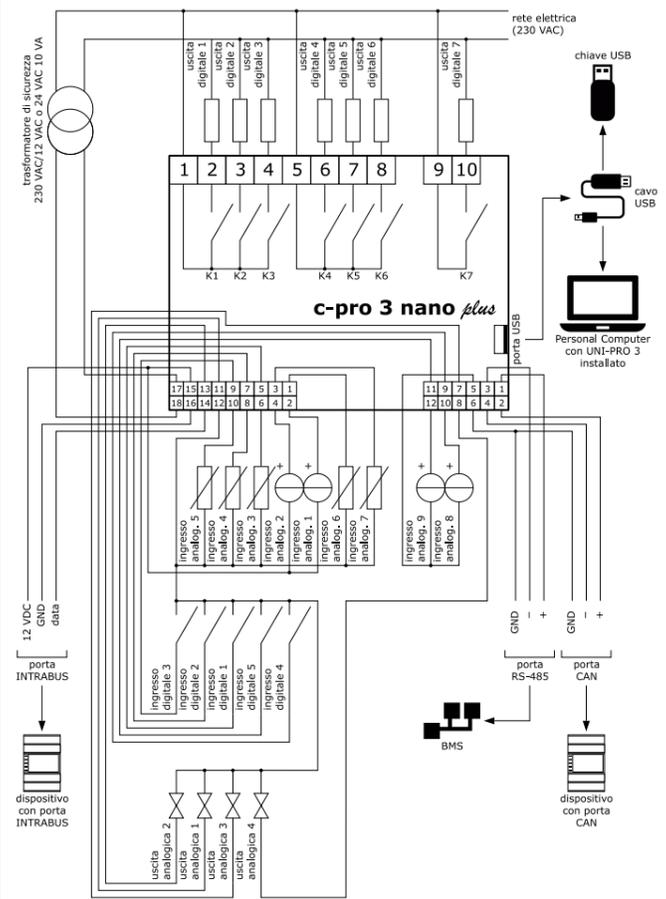
**2.3 Inserimento della resistenza di terminazione della rete RS-485 MODBUS, della rete CAN e polarizzazione della rete RS-485 MODBUS**
