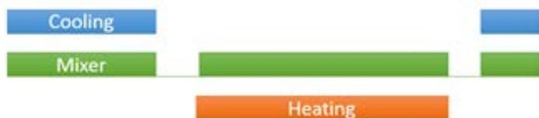
**Agitatore ON per carico ON (u13 = 0) e Agitatore ON/OFF in pausa regolazione (u14 = 1)**
