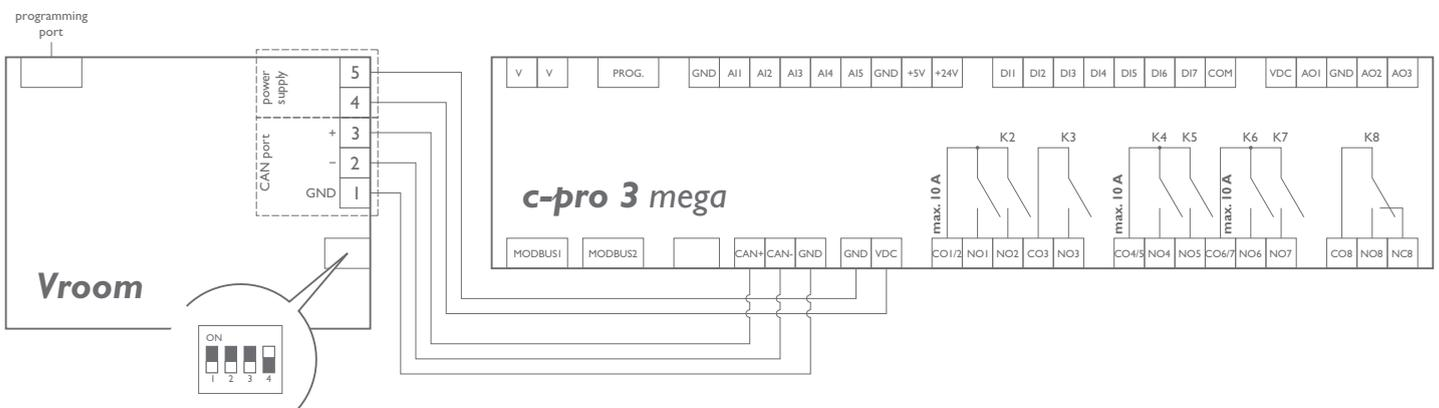
Posizionare il microinterruttore 4 nella posizione ON per inserire la terminazione della porta CAN; i microinterruttori 1, 2 e 3 sono riservati / Position micro-switch 4 on position ON to plug in the termination of the CAN port; micro-switches 1, 2 and 3 are reserved.
