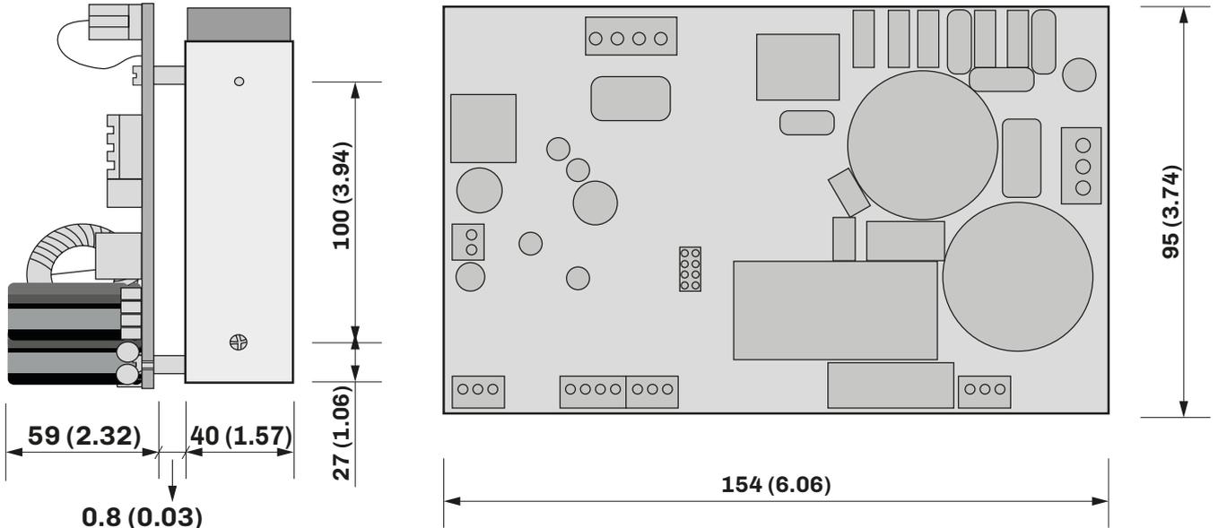
Fig. 2. Inverter dimensions
