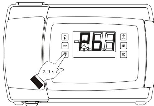
Accesso alla procedura per la visualizzazione delle ore di funzionamento del compressore
