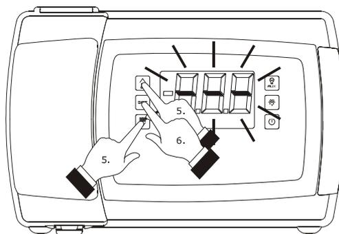
*Cancellazione delle ore di funzionamento del compressore*
