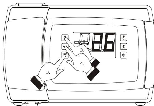
Visualizzazione delle ore di funzionamento del compressore
