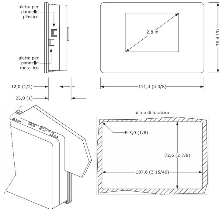
Il seguente disegno illustra le dimensioni dei modelli di interfaccia utente per installazione a parete (con tasselli e viti di fissaggio) o nelle più comuni scatola da incasso (con viti di fissaggio); le dimensioni sono espresse in mm (in).
