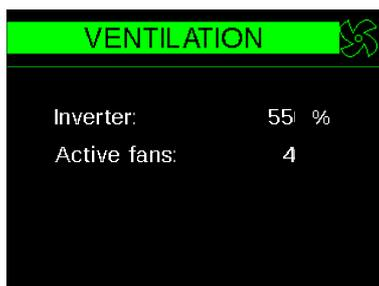
Se attiva la regolazione in proporzione alla regolazione di raffreddamento o riscaldamento, oltre allo stato di ogni ventilatore presente nell'unità, verranno visualizzati:
