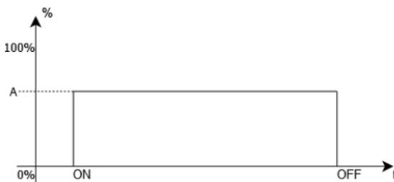
**A Velocità massima ventilatori (Setup costruttore - Configurazione ventilazione)**
