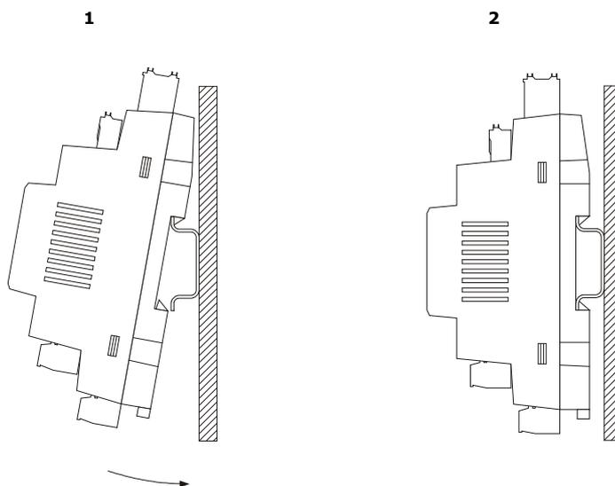
Per rimuovere il controllore principale rimuovere prima eventuali morsettiere estraibili a vite inserite nella parte bassa, quindi operare sulla clip per la guida DIN con un cacciavite nel modo indicato nel seguente disegno.
