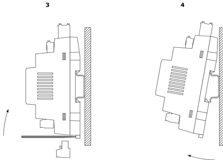
Per installare nuovamente il controllore principale premere prima a fondo la clip della guida DIN.
