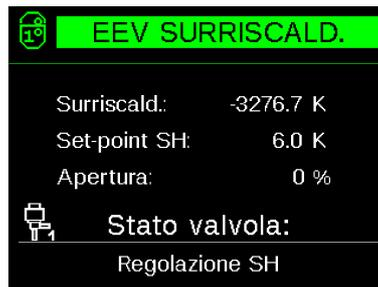
Successivamente viene monitorato lo stato della valvola di surriscaldamento, con relativo valore di surriscaldamento, setpoint di surriscaldamento e posizione della valvola.
