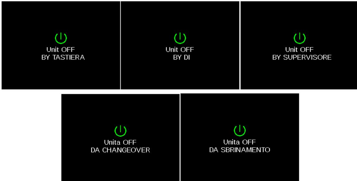
Premendo i tasti RIGHT o LEFT dalla pagina principale a macchina accesa sono inoltre visualizzabili le informazioni relative allo stato della macchina, delle regolazioni e delle sonde configurate.
