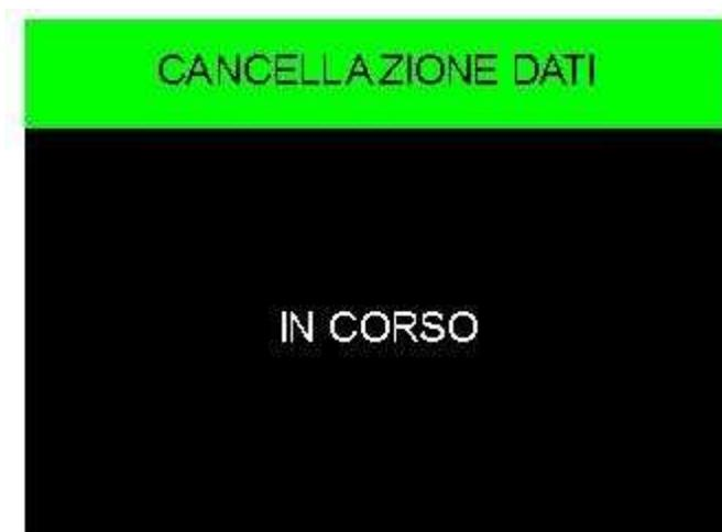
Per scaricare i dati registrati dalla scheda o per fare il download o upload dei parametri di configurazione, mettere la scheda in OFF e inserire una chiavetta USB nella porta USB presente sulla tastiera. Apparirà la seguente schermata
