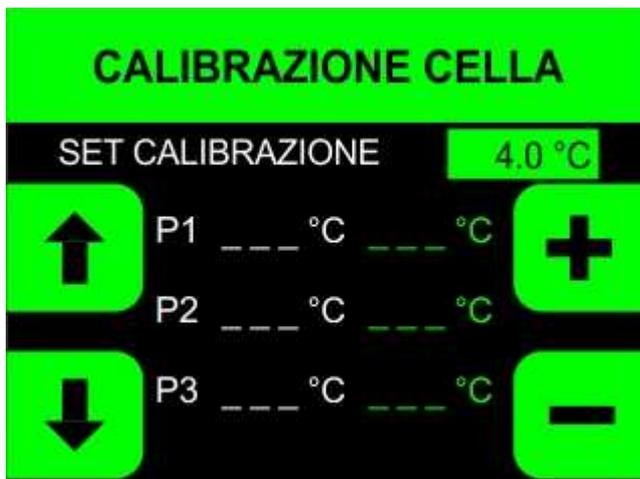
Premere i tasti + e - per impostare il corretto valore di setpoint e il tasto SET per avviare il funzionamento della macchina sul valore di setpoint impostato. Si visualizzerà la seguente schermata:
