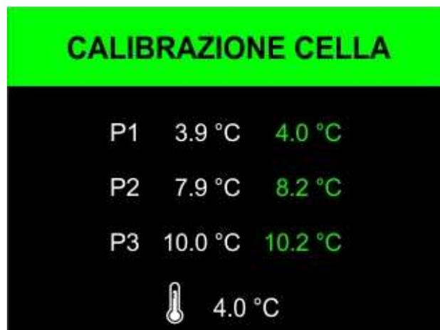
Durante la calibrazione non è possibile tornare indietro e ricalibrare un punto già calibrato. In caso si renda necessario modificare la calibrazione si deve ripetere completamente la procedura, premendo il tasto ESC e tornando alla schermata di selezione della sonda da calibrare.
