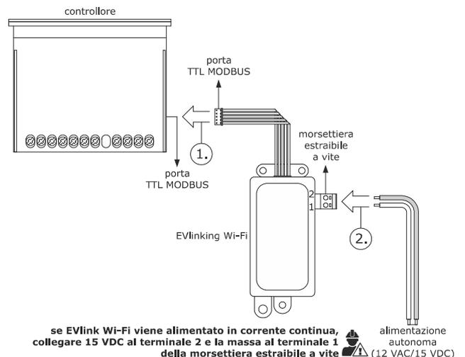
1. Connettere la porta TTL MODBUS di EVlinking Wi-Fi alla porta TTL MODBUS del controllore.
