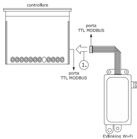
1. Connettere la porta TTL MODBUS di EVlinking Wi-Fi alla porta TTL MODBUS del controllore.
