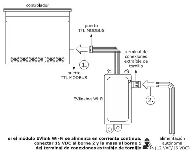
1. Conectar el puerto TTL MODBUS del módulo EVlinking Wi-Fi al puerto TTL MODBUS del controlador.
