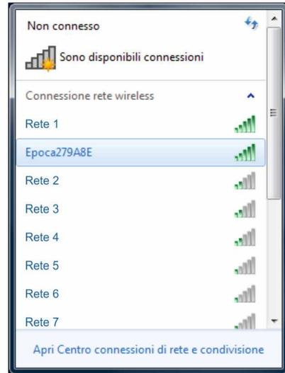
Si el escaneo detecta más de una red llamada **Epoca**, verificar que esté alimentado sólo un módulo EVlinking Wi-Fi.
