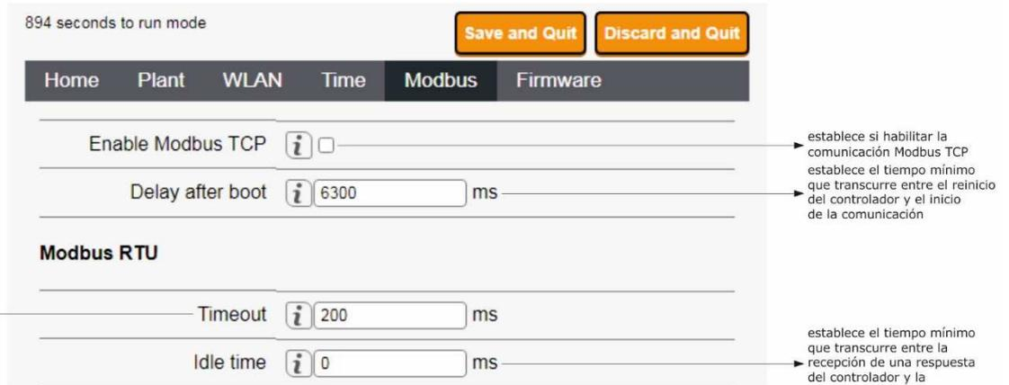
Si la comunicación Modbus TCP no está habilitada, el dispositivo solo funcionará con controladores EPoCA compatibles.
