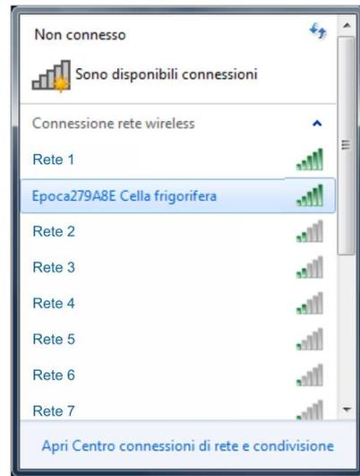
7. Conectarse a la red **Epoca**. En el campo **Llave de seguridad** introducir la contraseña que aparece en la etiqueta del módulo EVlinking Wi-Fi (normalmente **epocawifi**).
