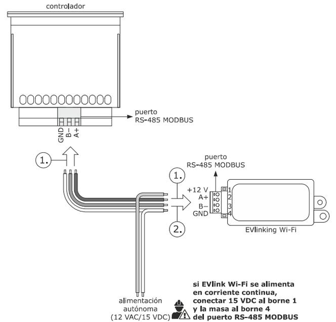
1. 1.1 Conectar el borne 4 del puerto RS-485 MODBUS del módulo EVlinking Wi-Fi (GND) al borne GND del puerto RS-485 MODBUS del controlador.
