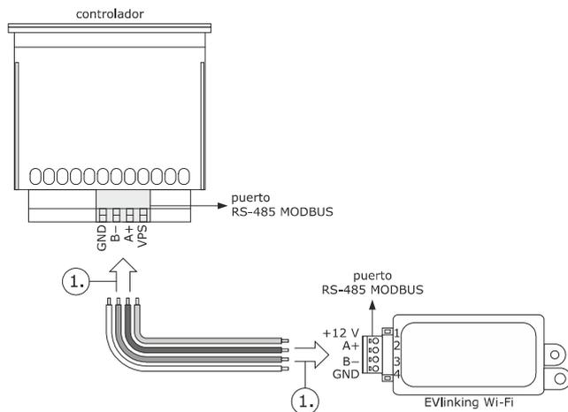
1. 1.1 Conectar el borne 4 del puerto RS-485 MODBUS del módulo EVlinking Wi-Fi (GND) al borne GND del puerto RS-485 MODBUS del controlador.
