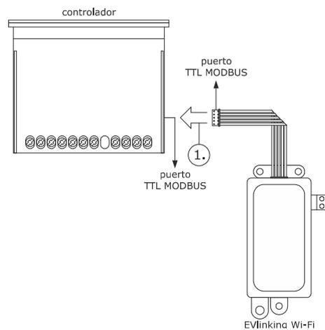
1. Conectar el puerto TTL MODBUS del módulo EVlinking Wi-Fi al puerto TTL MODBUS del controlador.
