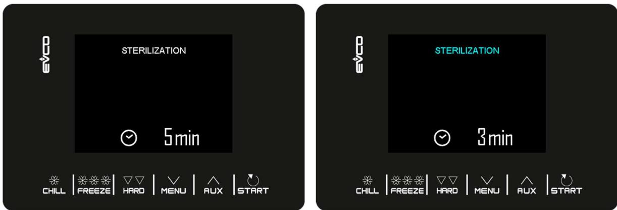
La sterilizzazione termina allo scadere del tempo dato da parametro u6, a seguito della pressione del tasto **START** per 2 secondi o dell'apertura della porta.
