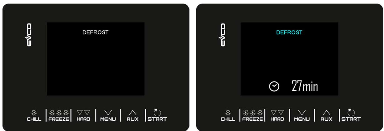
Lo sbrinamento viene eseguito anche in modo automatico durante le fasi di conservazione o di preraffreddamento ad intervalli di tempo definiti dal parametro d0, a condizione che il valore non sia impostato a 0.
