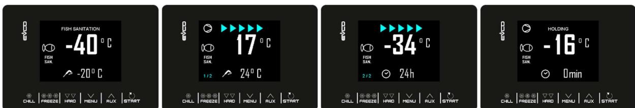
Durante l'esecuzione di una sanificazione, il dispositivo visualizzerà sempre la temperatura della cella e, a seconda della fase in corso, la temperatura di fine abbattimento o la durata del mantenimento.
