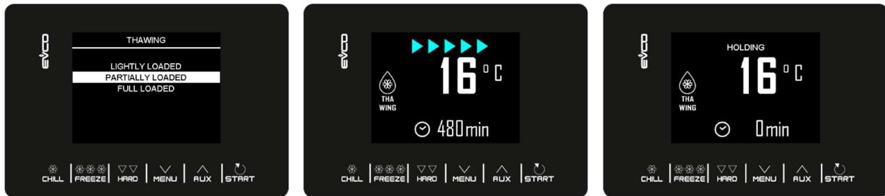
Il ciclo di scongelamento viene gestito in base alla quantità di carico di prodotto da scongelare inserito in macchina rispetto alla quantità massima dichiarata dal costruttore. Per semplicità, le quantità di carico selezionabili sono suddivise in tre fasce, per ciascuna delle quali il controllore caricherà tre diversi set di parametri predefiniti, secondo il seguente schema:
