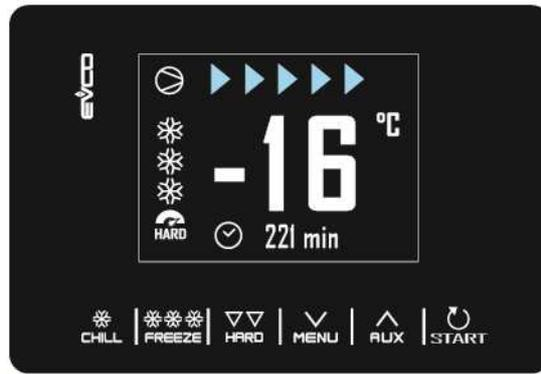
Una volta terminato il ciclo di abbattimento/surgelazione, per raggiunta temperatura della sonda spillone o per termine del tempo, il buzzer suona ed inizia la fase di conservazione; qualora il ciclo a temperatura non termini nei tempi consentiti, l'anomalia verrà segnalata dalla presenza del messaggio di allarme.
