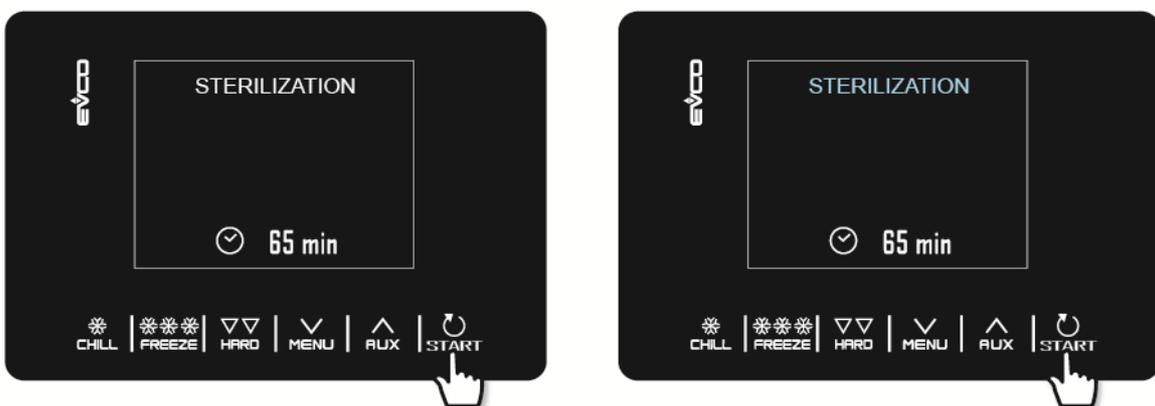
La sterilizzazione termina allo scadere del tempo dato da parametro u6, a seguito della pressione del tasto **START** per 2 secondi o dell'apertura della porta.
