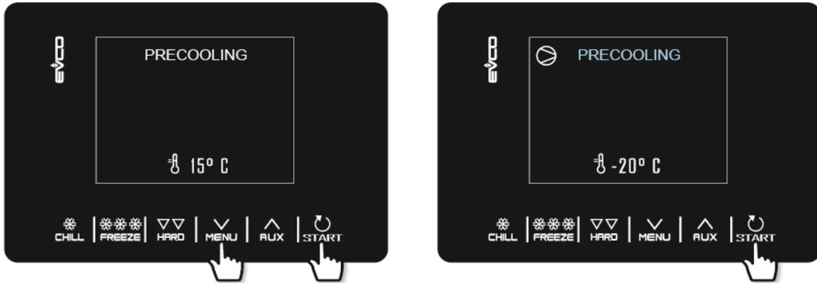
Una volta raggiunto il setpoint della cella desiderato, il buzzer suona, il ciclo continua mantenendo la temperatura della cella raggiunta fino a che si preme il tasto **START** per 2 secondi o fino all'avvio di un ciclo di abbattimento/surgelazione.
