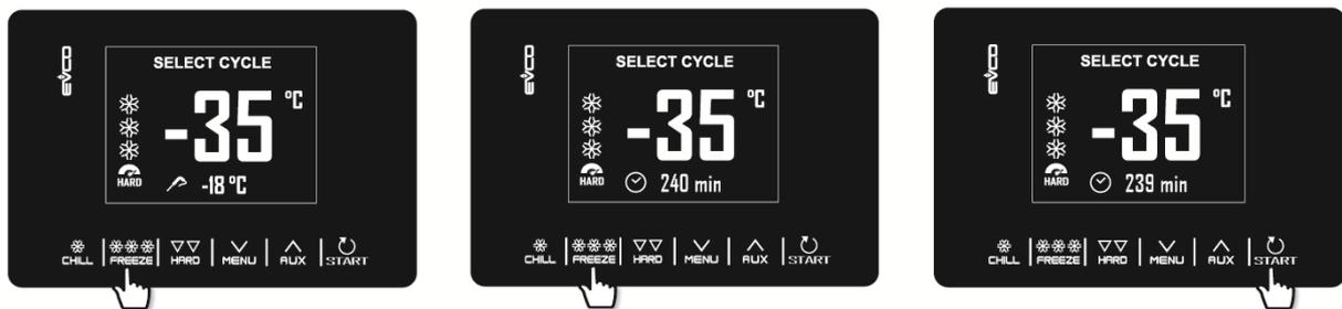
*Esempio di ciclo di surgelazione a temperatura (spillone), conversione in ciclo a tempo, modifica rapida della durata del ciclo di surgelazione e start ciclo.*
