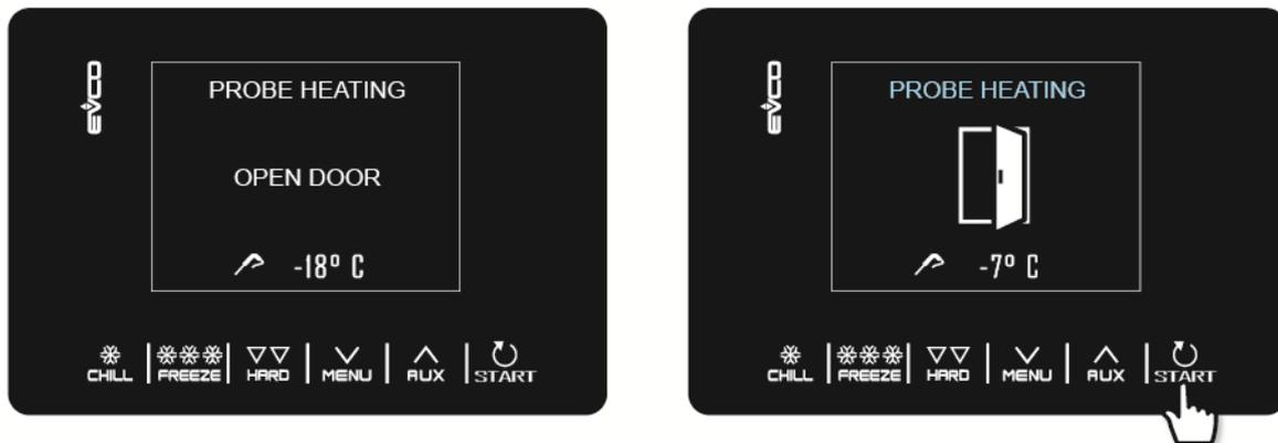
L'uscita riscaldamento sonda spillone viene attivata al massimo per il tempo stabilito con il parametro u8 o fino a quando la temperatura rilevata dalla sonda spillone raggiunge quella stabilita con il parametro u7.
