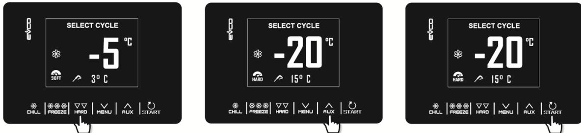
*Esempio di ciclo di abbattimento a temperatura (spillone), aggiunta di fase hard, modifica rapida del setpoint cella per la fase soft e start ciclo.*
