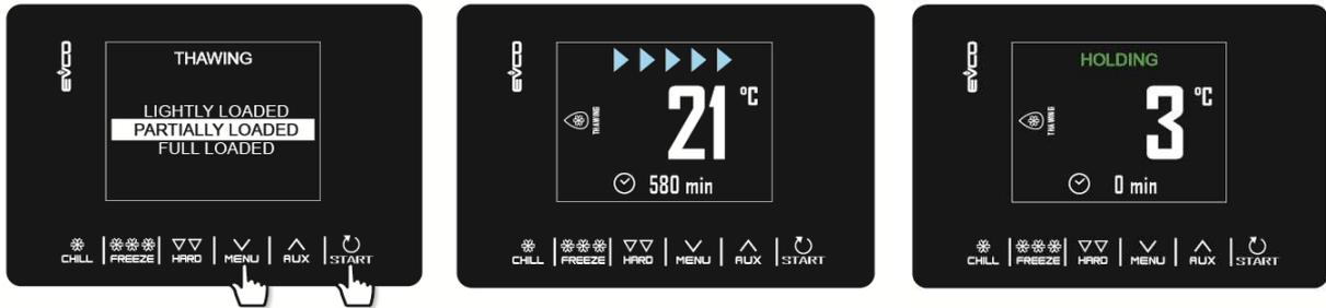
Il ciclo di scongelamento viene gestito in base alla quantità di carico di prodotto da scongelare inserito in macchina rispetto alla quantità massima dichiarata dal costruttore. Per semplicità, le quantità di carico selezionabili sono suddivise in tre fasce, per ciascuna delle quali il controllore caricherà tre diversi set di parametri predefiniti, secondo il seguente schema:
