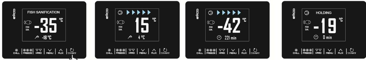
Durante l'esecuzione di una sanificazione, il dispositivo visualizzerà sempre la temperatura della cella e, a seconda della fase in corso, la temperatura di fine abbattimento o la durata del mantenimento.
