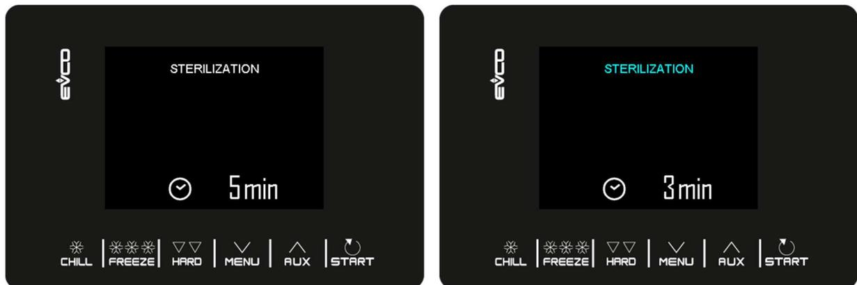
La sterilizzazione termina allo scadere del tempo dato da parametro u6, a seguito della pressione del tasto
