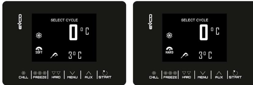
Il ciclo selezionato proporrà o le impostazioni precaricate per quel ciclo, o le impostazioni dell'ultimo ciclo eseguito (a seconda del parametro r36). Premendo **AUX** **MENU**, sarà possibile modificare rapidamente, entro i range ammessi, il valore di un singolo dato (stabilito da parametro r35).
