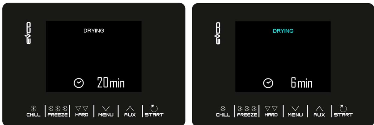
L'asciugatura termina allo scadere del tempo dato da parametro e1, a seguito della pressione del tasto
