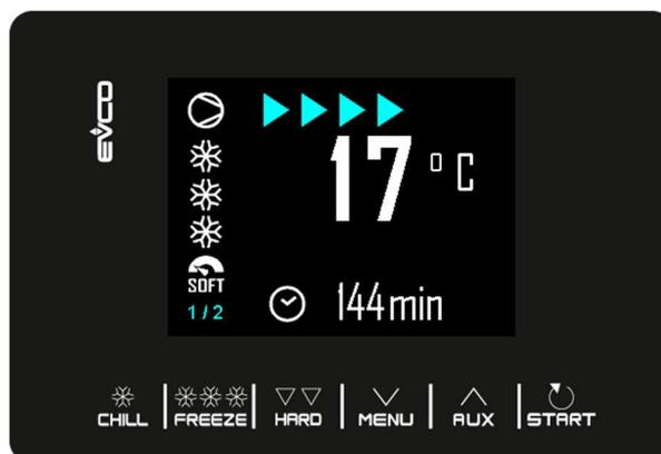
Una volta terminato il ciclo di abbattimento/surgelazione, per raggiunta temperatura della sonda spillone o per termine del tempo, il buzzer suona ed inizia la fase di conservazione; qualora il ciclo a temperatura non termini nei tempi consentiti, l'anomalia verrà segnalata dalla presenza del messaggio di allarme.
