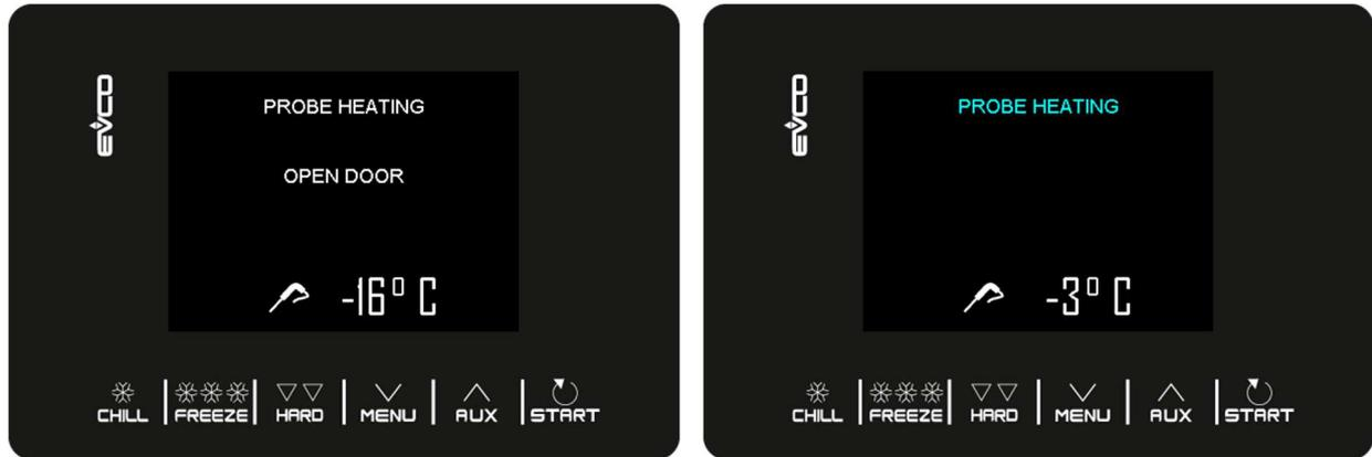
L'uscita riscaldamento sonda spillone viene attivata al massimo per il tempo stabilito con il parametro u8 o fino a quando la temperatura rilevata dalla sonda spillone raggiunge quella stabilita con il parametro u7.
