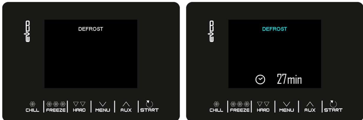
Lo sbrinamento viene eseguito anche in modo automatico durante le fasi di conservazione o di preraffreddamento ad intervalli di tempo definiti dal parametro d0, a condizione che il valore non sia impostato a 0.
