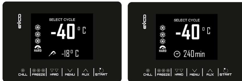
Se il ciclo è a temperatura, viene eseguito il test per verificare il corretto inserimento della sonda spillone nell'alimento da abbattere. Se il test non viene superato, il ciclo si commuta automaticamente sulla modalità a tempo: il buzzer emette un suono e sul display viene convertito il tipo di controllo del ciclo da temperatura a tempo. Per maggiori dettagli sulla modalità di esecuzione del test, cfr il paragrafo 6.2.
