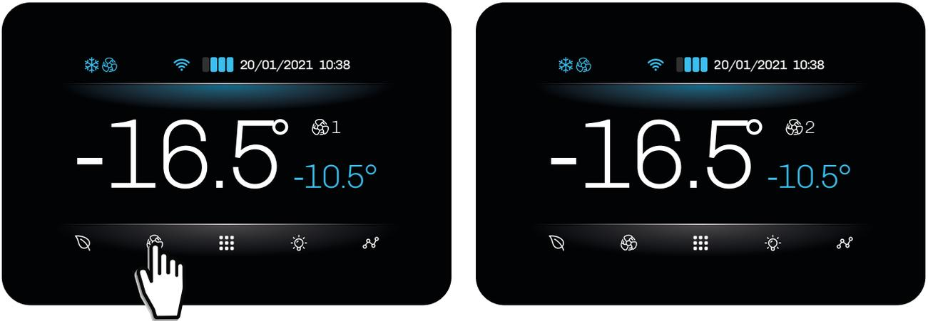
Fig. 29. Change evaporator fan speed
