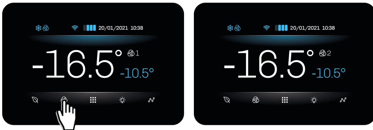
Fig. 29. Cambio velocità ventole evaporatore
