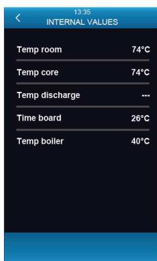
In questa schermata si visualizzano solamente gli stati macchina principali. Per accedere alla visualizzazione di tutti gli stati interni è necessario inserire nella schermata SERVICE la password +19. I privilegi dell'accesso con log-in SERVICE verranno mantenuti fino a quando si toglierà tensione al dispositivo.
