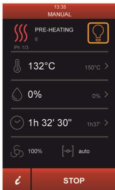
Avvio del ciclo di cottura e Preriscaldamento
