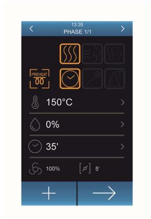
Selezione del preriscaldamento, del tipo di cottura e del metodo di controllo fase.
