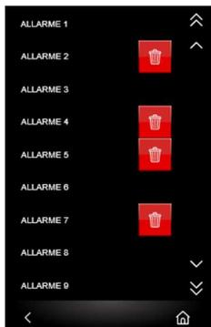
Nel caso di un allarme resettabile manualmente, alla destra dell'allarme attivo appare un tasto che se premuto attiva la procedura di reset allarme.
