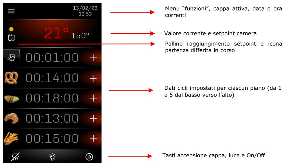
Con il passaggio allo stato On, il dispositivo attiva automaticamente la regolazione della temperatura: nella parte superiore della schermata viene riportata la temperatura corrente della camera e a fianco il setpoint della camera. Premendo sui valori di temperatura si passa ad una schermata con tastierino per la modifica rapida del setpoint (vedere paragrafo successivo).
