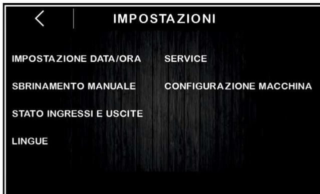
Se il parametro E12 è posto a 1, nella schermata apparirà anche la voce di configurazione dell'umidificatore con comando seriale.
