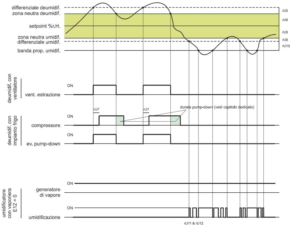
Se il parametro E12 è posto a 1, l'uscita generatore si attiva solo quando l'umidità si porta sotto il valore di zona neutra (dato dal parametro rU9) oltre la soglia impostata con rU8 (differenziale umidificazione). L'uscita umidificatore si attiva invece a cicli di off e di on quando richiesto, partendo sempre dal tempo di off per permettere al generatore di vapore di essere pronto per generare umidità.
