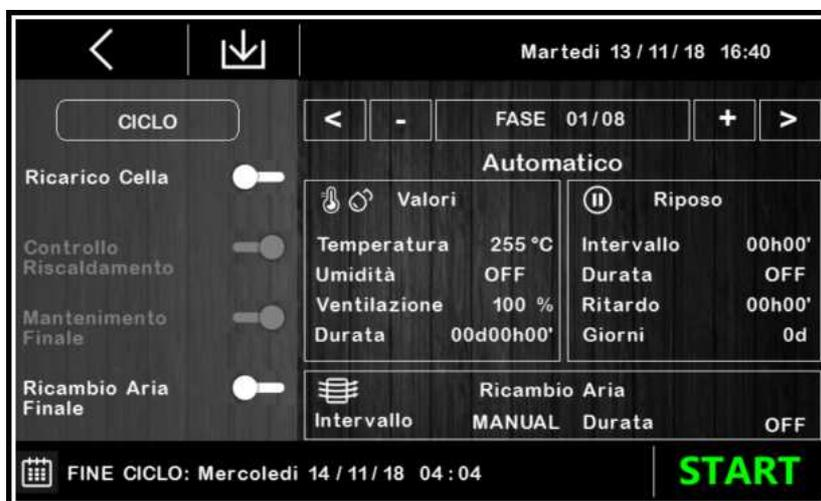
Il ciclo automatico si avvia con una pressione dell'area **START** e termina automaticamente, alla fine dell'ultima fase impostata, con una segnalazione acustica.
