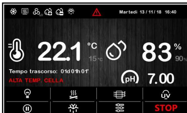
La barra superiore indicherà lo stato delle uscite/stati principali di regolazione (caldo / freddo / umidifica / deumidifica / stato ventilazione /sbrinamento), un eventuale stato di allarme (icona allarme, sempre associato alla descrizione) e l'ora-data attuali.
