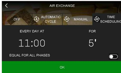
Quando la ricetta è in esecuzione, se è attivo il ricambio aria, l'icona lampeggia. In ogni momento dell'esecuzione della ricetta è possibile premere il tasto di ricambio aria ed eseguire un ricambio d'aria manuale, indipendentemente dalle modalità impostate.
