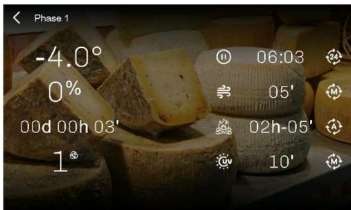
Toccando il nome della fase nell'area superiore del display appare una lista di nomi che si possono selezionare per rinominare la fase; toccando la freccia nell'area superiore del display si tornerà alla griglia riassuntiva. Selezionando i differenti campi è possibile modificarne i valori tramite un tastierino numerico.
