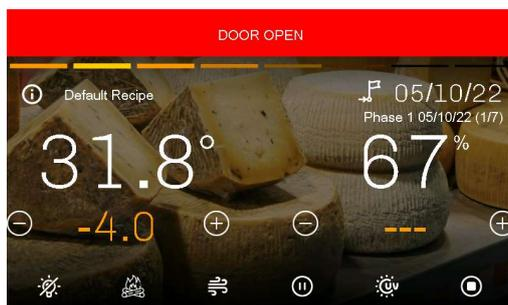
Premendo la barra degli allarmi, il buzzer verrà tacitato e il controllore passerà automaticamente nella schermata della LISTA ALLARMI dove saranno visibili solo quelli attivi.
