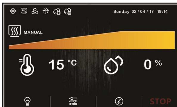
**Nota:** il ciclo manuale non prevede impostazioni di durata, si può terminare solo manualmente tramite la pressione del tasto **STOP**.
