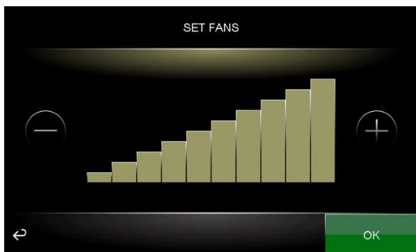
Selezione velocità ventilatore (es. con 10 velocità)
