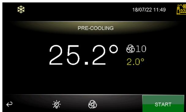
Quando il ciclo viene attivato, il controllore si riporterà automaticamente nella pagina principale visualizzando nel tasto di pre-raffreddamento la temperatura della cella e il setpoint da raggiungere.
