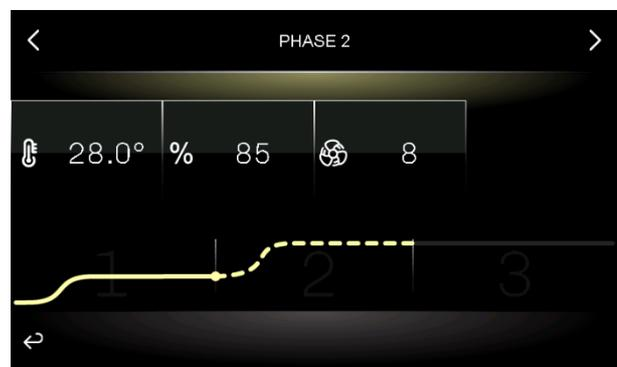
La regolazione di temperatura è attiva ed è a zona neutra, il setpoint di lavoro è stabilito dall'utilizzatore finale. Il passaggio dal setpoint di risveglio (fase precedente) al setpoint di lievitazione può essere graduale con percentuali di incremento stabilite in fase di impostazione parametri (parametri da rL0 a rL10).
