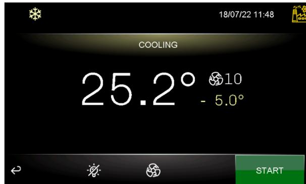
Prima dell'avvio del ciclo desiderato, è possibile modificare i valori del setpoint temperatura e la velocità del ventilatore; se non viene impostato nessun timer per terminare il ciclo dopo un tempo predefinito, il ciclo continua all'infinito.
