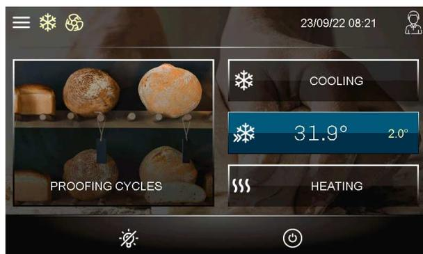
Al primo raggiungimento del setpoint impostato, il controllore emetterà un segnale acustico. Qualora la temperatura in cella sia uguale o inferiore al setpoint impostato, la funzione di pre-raffreddamento non sarà attivabile.
