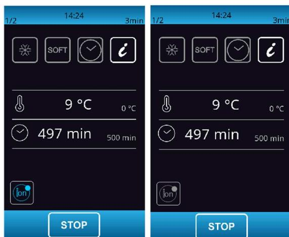
Se lo ionizzatore è attivo ma la temperatura della cella scende al di sotto dei 0°C, lo ionizzatore viene spento (icona tasto disattivato) e rimane in questa condizione anche se la temperatura della cella dovesse risalire sopra 0°C (in questo secondo caso però l'utente può riattivare lo ionizzatore manualmente da tasto).
