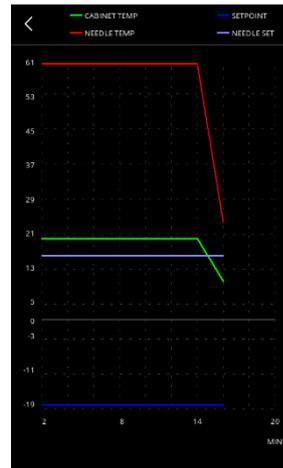
Una volta terminato il ciclo di abbattimento/surgelazione, per raggiunta temperatura della sonda spillone o per termine del tempo, il buzzer suona ed inizia la fase di conservazione.
