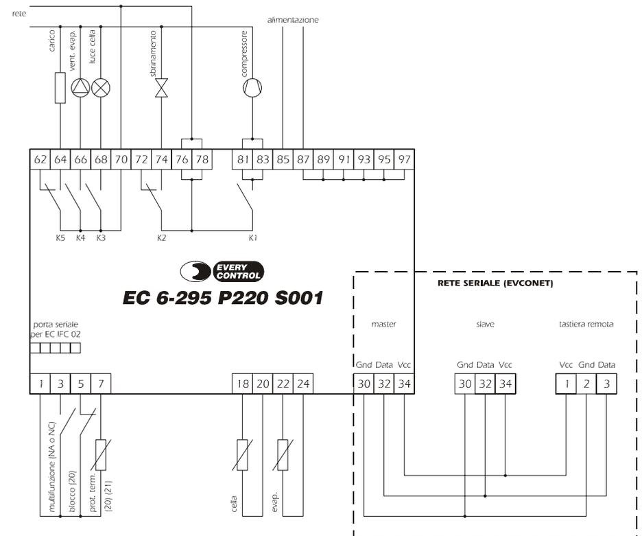
(20) qualora l'ingresso di blocco e/o la sonda per la protezione termica del compressore non vengano utilizzati cortocircuitare i morsetti 1 e 5 e/o 1 e 7
