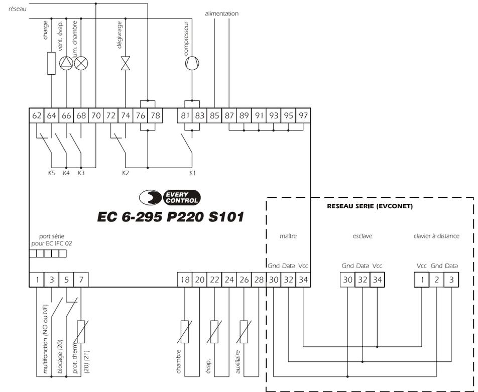
(20) si l'entrée de blocage et/ou la sonde pour la protection thermique du compresseur ne sont pas utilisées court-circuiter les bornes 1 et 5 et/ou 1 et 7
