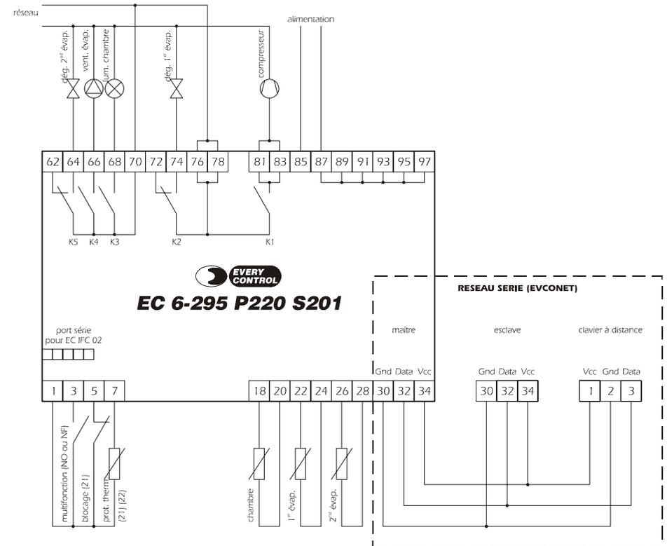
(21) si l'entrée de blocage et/ou la sonde pour la protection thermique du compresseur ne sont pas utilisées court-circuiter les bornes 1 et 5 et/ou 1 et 7
