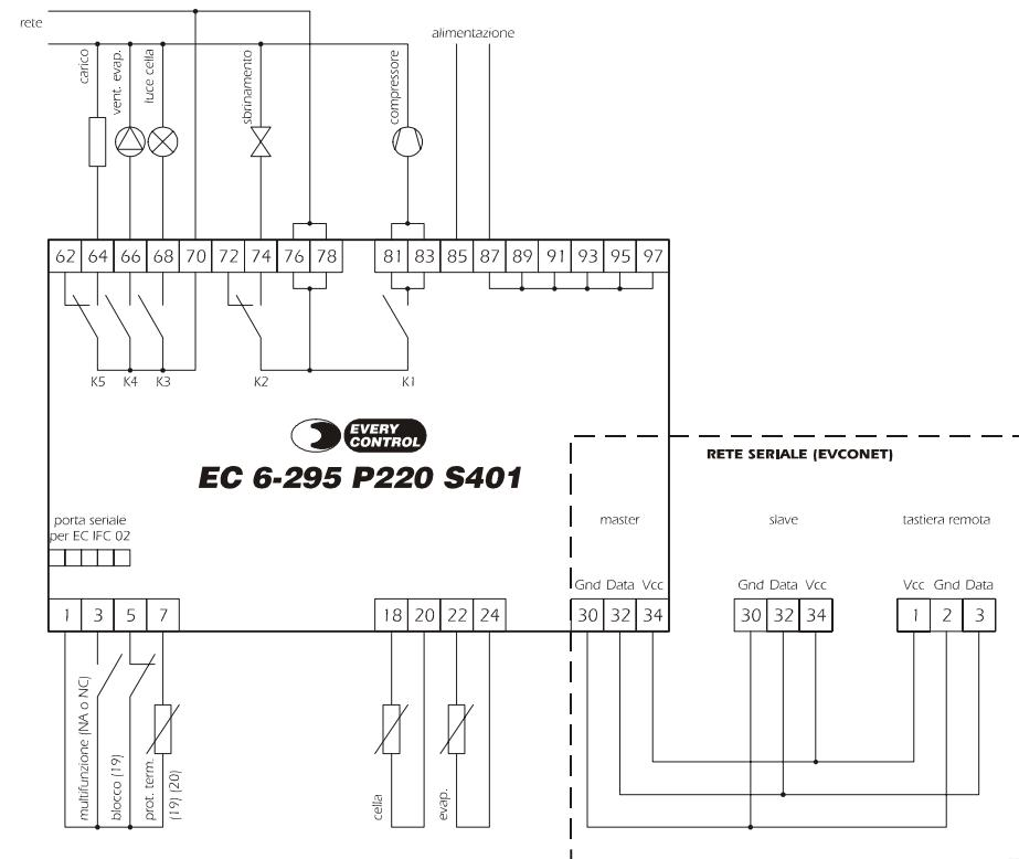
(19) qualora l'ingresso di blocco e/o la sonda per la protezione termica del compressore non vengano utilizzati cortocircuitare i morsetti 1 e 5 e/o 1 e 7
