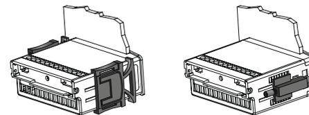
Montage mit (mitgelieferten, links) Einrastbügeln und Schraubenbügeln (auf Anfrage, rechts):
