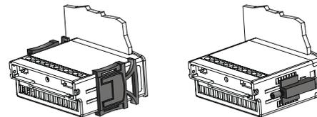
instalación con soportes para anclaje a presión (a la izquierda, de serie) y mediante tornillos
