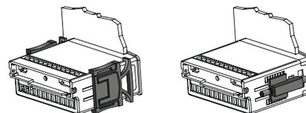
installazione con staffe a scatto (a sinistra, in dotazione) e con staffe a vite (a destra, su richiesta); per evitare di danneggiare il contenitore e le staffe a vite, moderare la coppia di serraggio.
