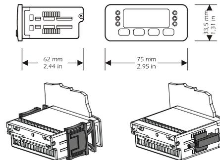
installation avec étriers à ressort (à gauche, en standard) et à vis (à droite, sur demande); pour éviter d'abîmer le boîtier et les étriers à vis, modérer le couple de serrage.
