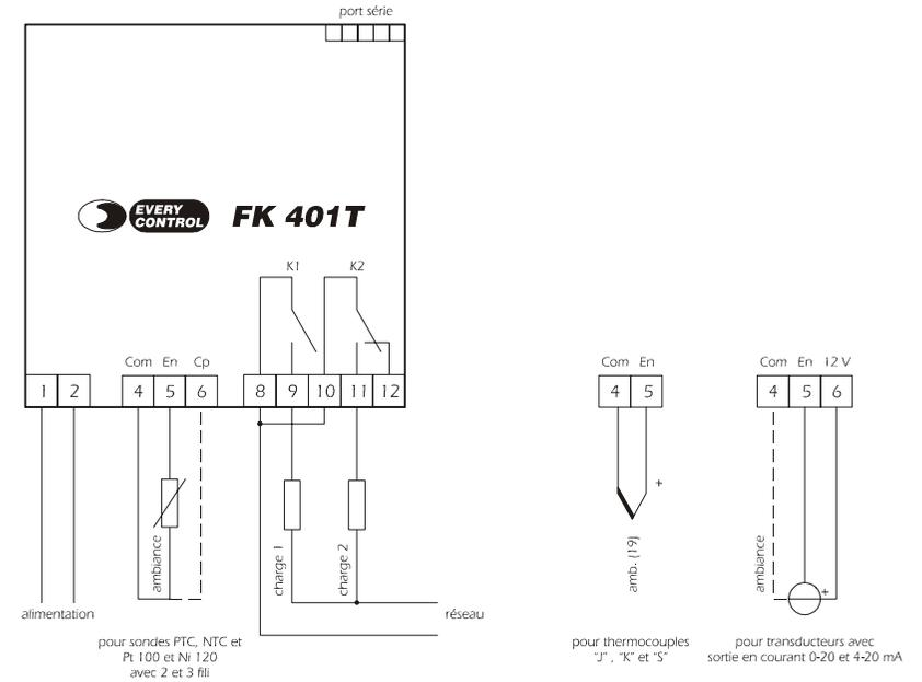
[19] doter la sonde d'une protection capable d'isoler-la contre les parties métalliques ou utiliser des sondes avec isolement.
