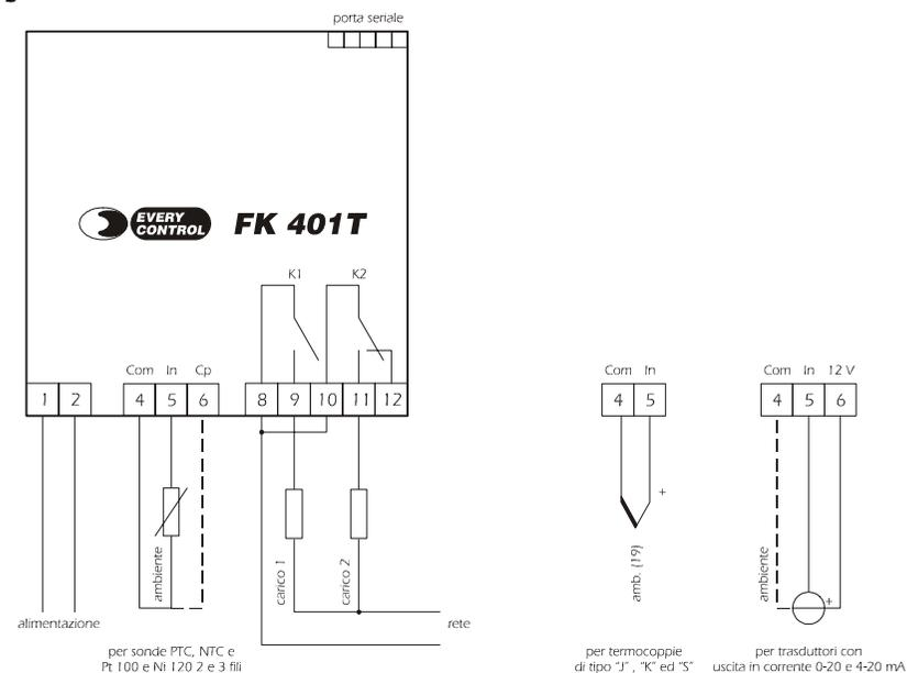
(19) dotare la sonda di una protezione in grado di isolarla contro eventuali contatti con le parti metalliche o utilizzare una sonda isolata.
